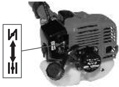
Рис. 14 Рычаг управления воздушной заслонкой карбюратора
