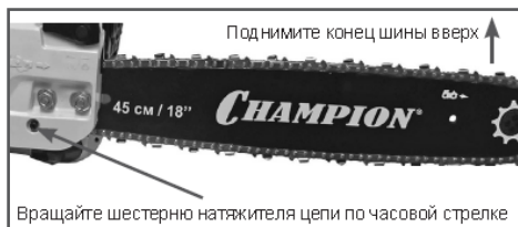
Рис. 5 Регулировка натяжения цепи
