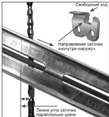
Рис. 28 Определение угла заточки
