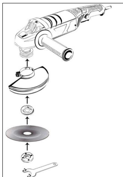
Рис. 6. Установка круга
