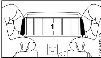
**1** = Воздушный фильтр откиньте указательными пальцами в направлении задней ручки, при этом, большие пальцы опираются о корпус.
