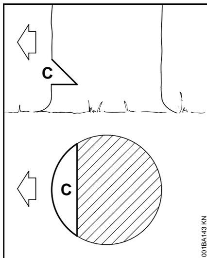
**C** = Подпил определяет направление валки дерева.
