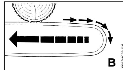
Если при пилении верхней стороной направляющей шины – задний рез – пильная цепь защемляется или наталкивается на твердый предмет в древесине, то пила может быть отброшена назад в сторону пользователя. – **Во избежание этого:**
