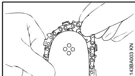
**⚠** Надеть защитные перчатки – Опасность травмы острыми режущими зубьями.
