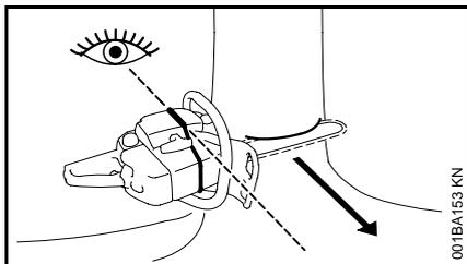
Выбранное направление валки дерева при проведении подпила может контролироваться с помощью валовой планки на коже, а также на корпусе вентилятора моторной пилы.
