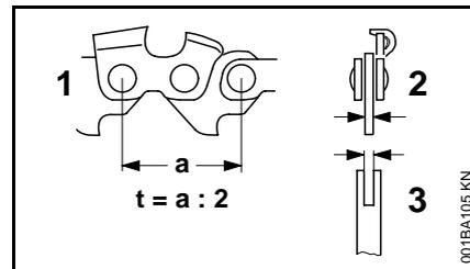
На этой моторной пиле могут применяться пильные цепи с различным шагом - в зависимости от монтируемой цепной звездочки (см. "Технические данные"):
