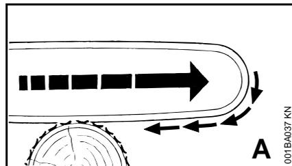
Если при пилении нижней стороной направляющей шины – передний рез – пильная цепь защемляется или наталкивается на твердый предмет в древесине, то пила может быть затянута рывком в сторону ствола, – **поэтому всегда уставляйте надежно зубчатый упор!**
