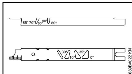
пользуйтесь опилочным калибром\* фирмы STIHL (специальные принадлежности, см. таблицу "Заточной инструмент"), – универсальный инструмент для контроля угла заточки и переднего угла, высоты ограничителя глубины, длины зуба, глубины паза и для очистки пазов и впускных масляных отверстий.
