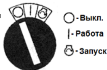
Рис.4. Замок зажигания (электростартер). Ключ в положении "О" (Выкл.).
