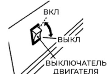
После запуска двигателя верните ключ в положение ON. Не используйте стартер более 5 секунд за один запуск. Если двигатель не запускается, отпустите выключатель и подождите 10 секунд перед повторным запуском.
