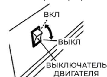
После запуска двигателя верните ключ в положение ON. Не используйте стартер более 5 секунд за один запуск. Если двигатель не запускается, отпустите выключатель и подождите 10 секунд перед повторным запуском.
