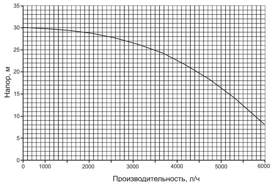
**Рисунок 1** — Диаграмма зависимости производительности мотопомпы от напора
