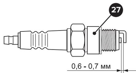
27. Свеча зажигания
