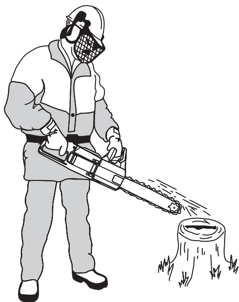
Рисунок 10 — Контроль устройства автоматической смазки режущей гарнитуры
