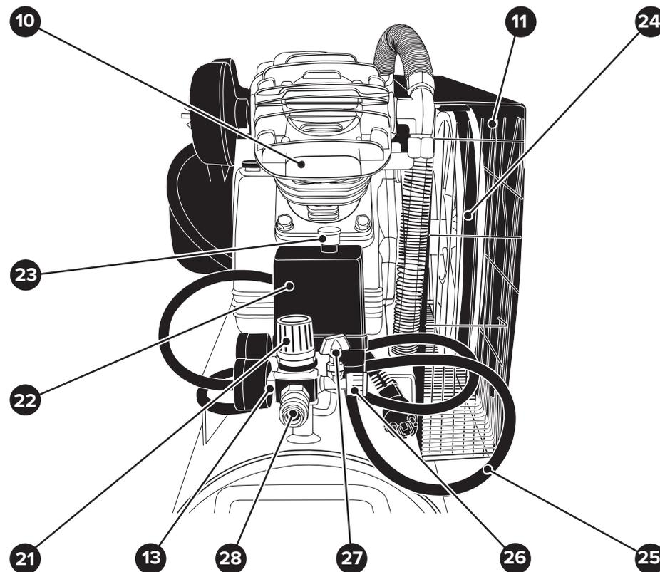
Рисунок 2.2 — Блок управления компрессором АС-440-50-BDV (ID 1119)
