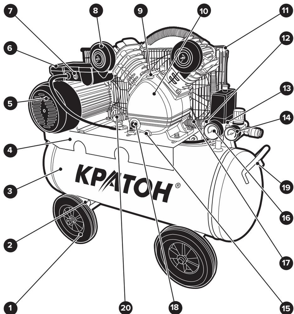
Рисунок 1.2 — Общий вид компрессора АС-440-50-BDV (ID 1119)
