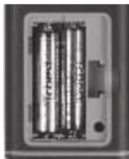
Откройте крышку батарейного отсека на задней части прибора, вставьте батареи, соблюдая полярность, затем закройте крышку.
