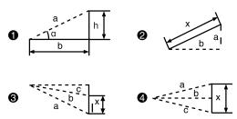
а) Расчет длин катетов через измерение гипотенузы и угла.
