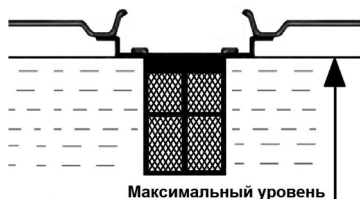
Рис. 9. Максимальный уровень топлива в топливном баке
